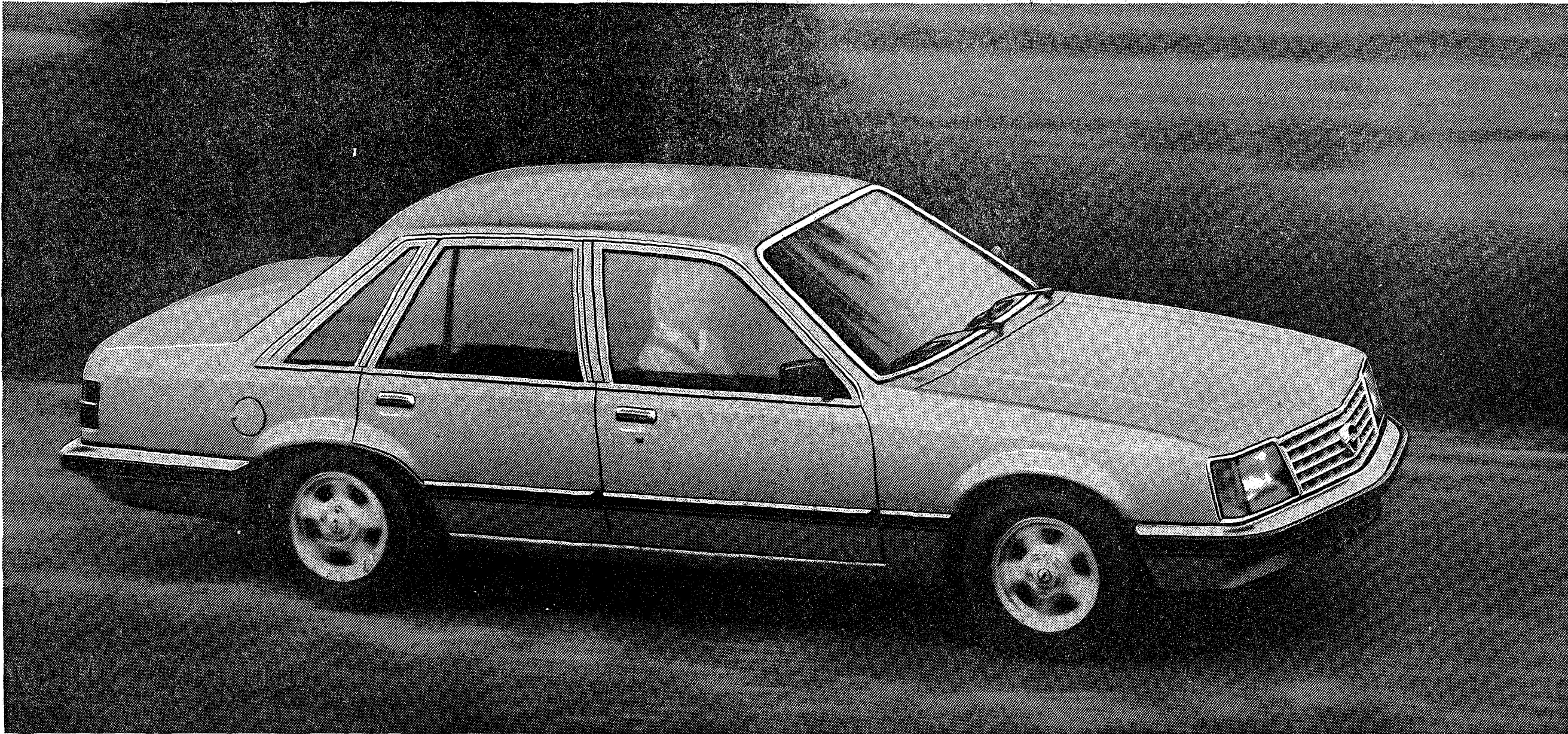
Die Abb. zeigt den Senator C. Technische Daten: 2,8 l-S-Motor, 103 kW (140 PS); 3,0 l-S-Motor, 110 kW (150 PS); 3,0 l-E-Motor, 132 kW (180 PS).
